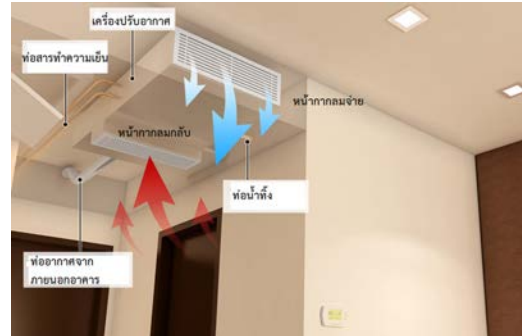
รูปแสดง เครื่องปรับอากาศแบบแยกส่วนที่มีท่อส่งลมเย็นสั้นๆพร้อมหน้ากากลม
